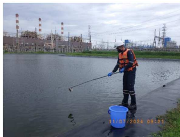
จุดตรวจวัดน้ำทิ้งบริเวณบ่อกักน้ำทิ้งรวม (Holding Pond) ของโรงไฟฟ้าบางปะกง
