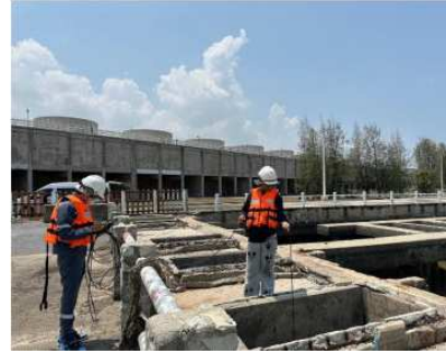
รูปที่ ค-60 การตรวจวัดการแพร่กระจายอุณหภูมิน้ำหล่อเย็นของโรงไฟฟ้าบางปะกง (ดำเนินการตรวจวัดเมื่อวันที่ 23 เมษายน 2567)
