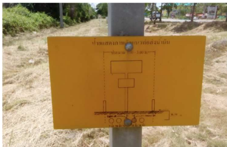
รูปที่ ค-37 ป้ายแสดงแนวท่อและขอบเขตพื้นที่ข้างแนวทอลำเลียงก๊าซธรรมชาติ
