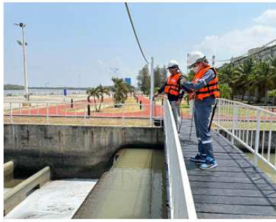
รูปที่ ค-60 การตรวจวัดการแพร่กระจายอุณหภูมิน้ำหล่อเย็นของโรงไฟฟ้าบางปะกง (ดำเนินการตรวจวัดเมื่อวันที่ 23 เมษายน 2567)
